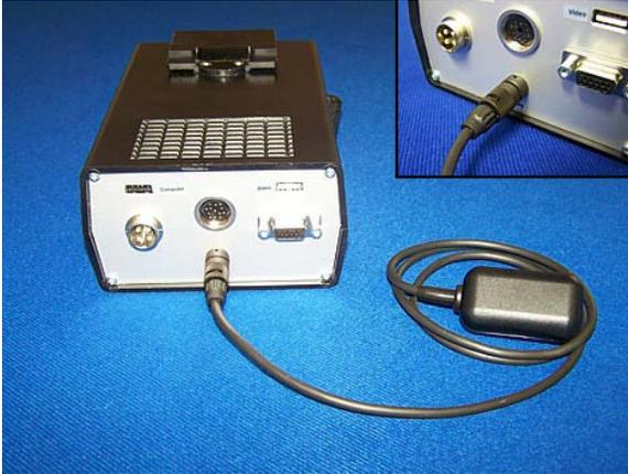
**Paso 1** Si te gusta grabar y guardar los datos GPS de sus medidas que debe conectar el receptor GPS entregado.
