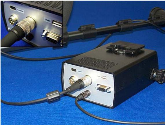
**Paso 2** Conecte la sonda que le gusta usar a la unidad de control. No importa que la sonda que está utilizando, usted va a utilizar siempre el mismo enchufe en cada sonda de exploración.
