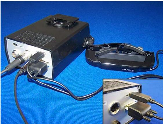
**Paso 3** Las gafas de vídeo se compone de 2 conectores, video y audio. Tenga cuidado al conectar el cable USB directamente sobre el conector de vídeo de 15 polos.
