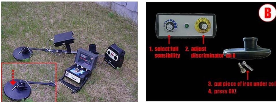
*Ilustración 9.4: Calibración del sistema DDV, el paso 2*
