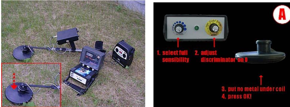
*Ilustración 9.3: Calibración del sistema DDV, el paso 1*
