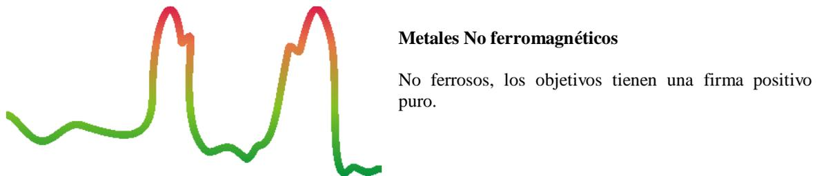
*Ilustración 7.14: Firma de un blanco de metal no ferromagnético*
