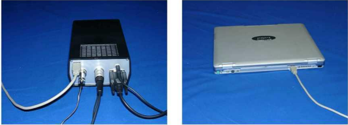
Şekil 5: USB Veri Kablosunun Bağlantısı
