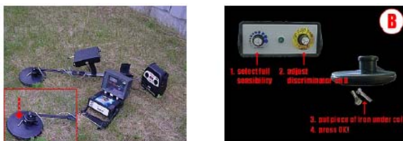
Ilustración 9.4: Calibración del sistema DDV, el paso 2
