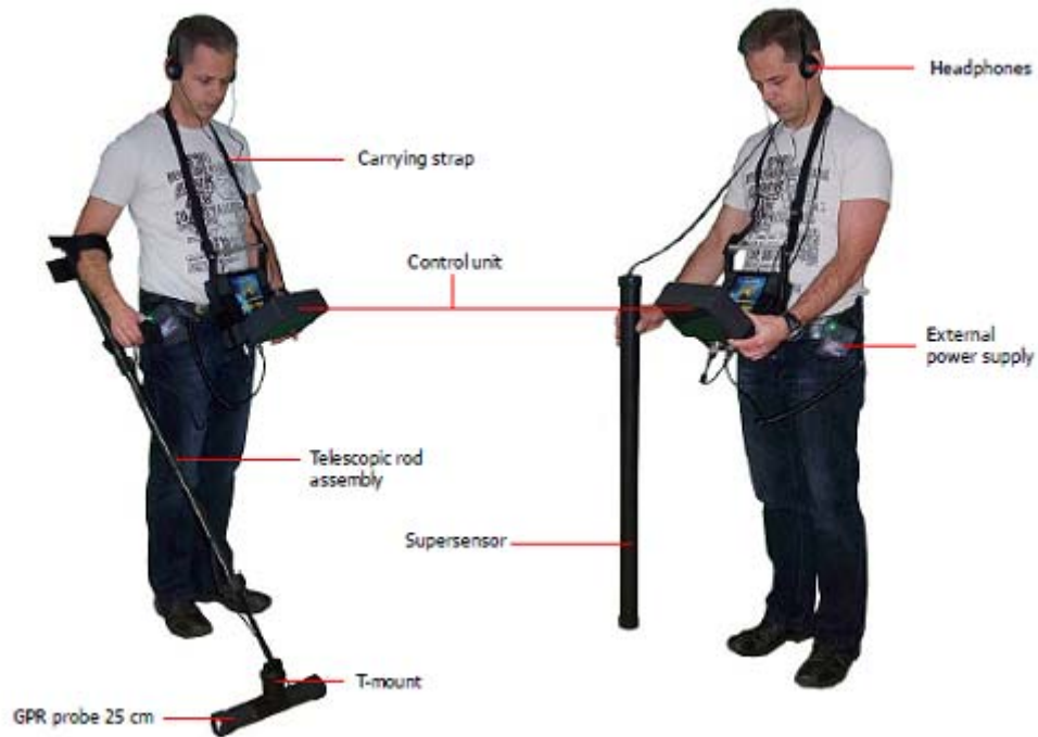
Ilustración 6.1: Unidad de control con fuente de alimentación y la sonda
