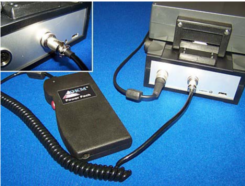
Ilustración 5.2: Conexión del Power Pack
