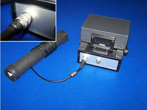
Ilustración 5.1: Conexión de la sonda
