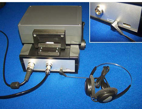
Ilustración 5.3: Conexión de los auriculares
