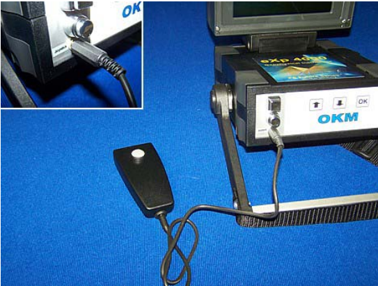
Ilustración 5.4: Conexión del joystick
