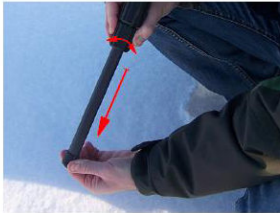
شکل ۲.۵ بلندتر کردن آنتن تلسکوپیک
