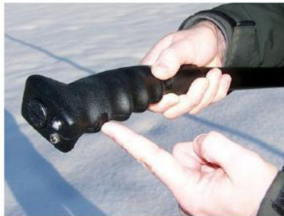
شکل ۳.۵ روشن کردن آنتن تلسکوپیک
