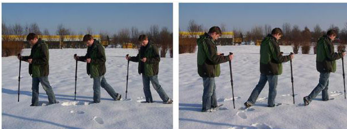
شکل ۶.۶ اسکن زیگزاگ در روش عملکرد " اسکن زمین به طور دستی "
