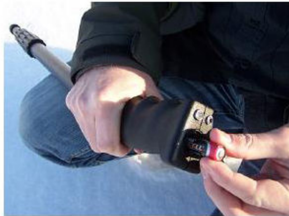
شکل ۵ . ۱ وارد کردن باتری ها درون آنتن تلسکوپیک
