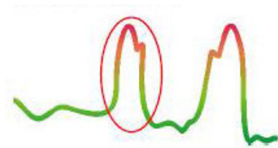
شکل ۱۵ . ۶ علامت شی non- ferromagnetic
