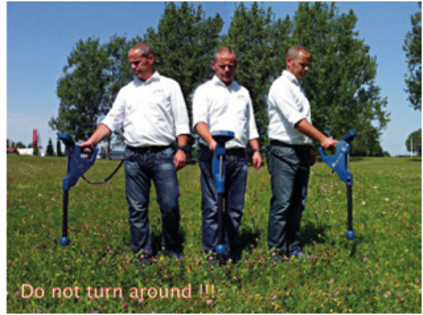
رسم 10-7: تدوير المجس يؤدي إلى نتيجة قياس مزيفة
