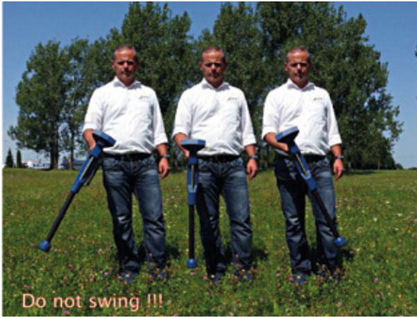
رسم 10-7: تدوير المجس يؤدي إلى نتيجة قياس مزيفة
