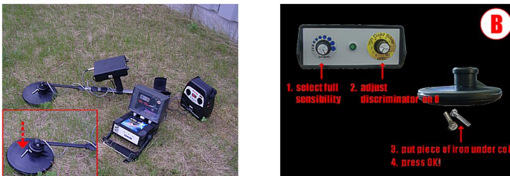
Abbildung 21: Kalibrierung des DDV-Systems, Schritt 2
