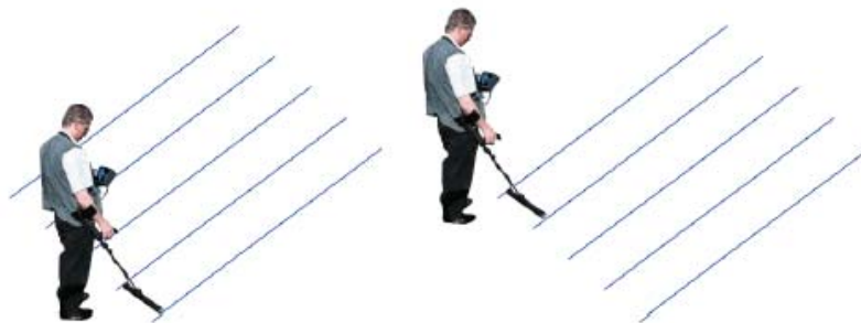
Figura 44: Medición con sonda horizontal
