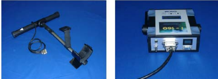
Figura 2: Montaje y conexión de la sonda
