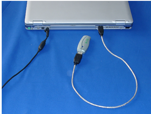
Abbildung 4: Anschluß des USB-Dongles
