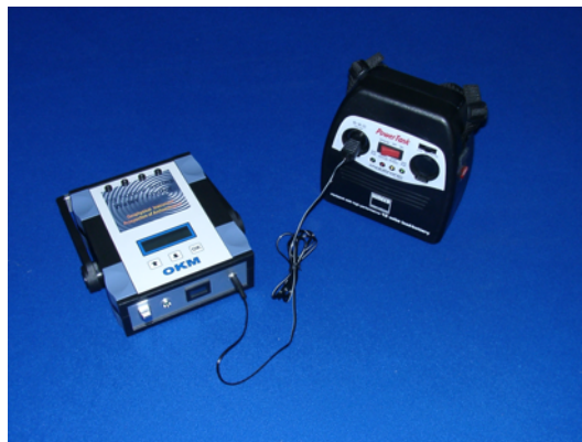
Abbildung 3: Anschluss der Externen Stromversorgung
