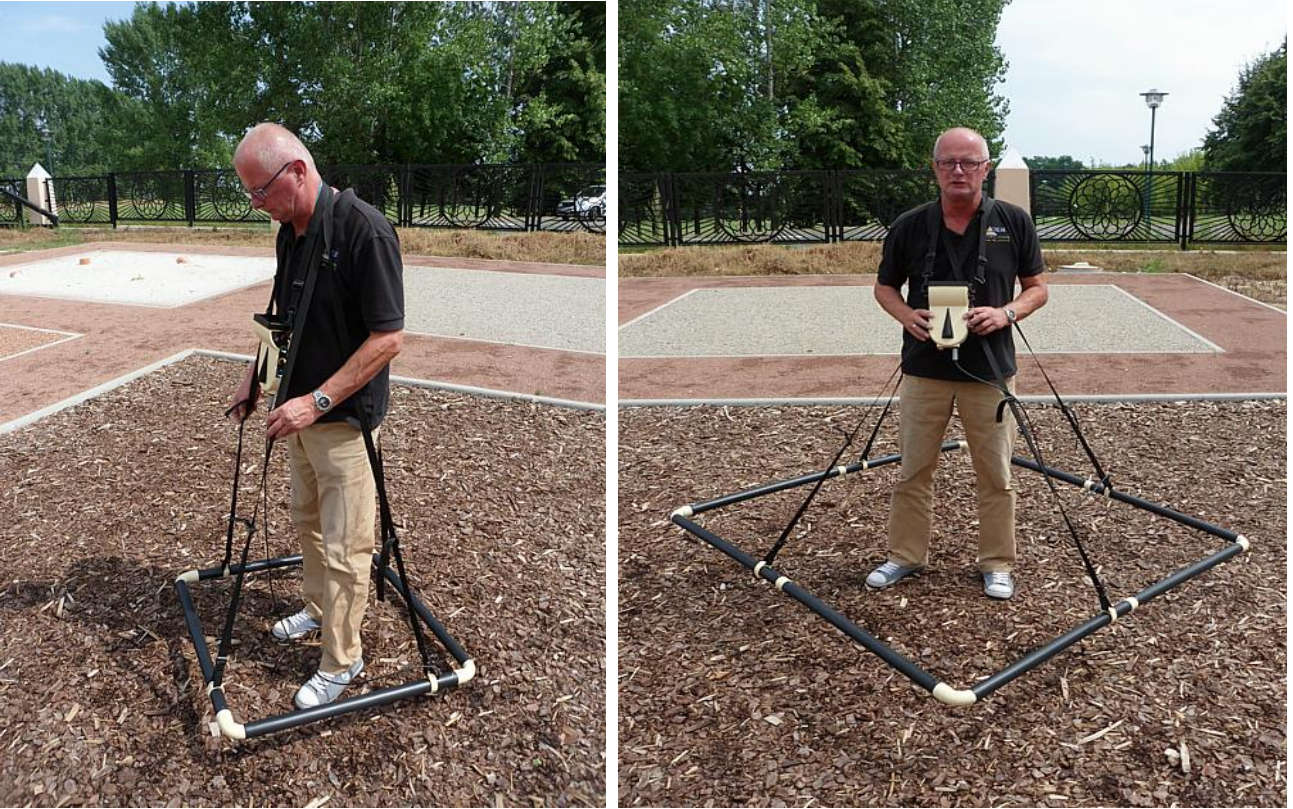
4.19: Çerçeve bobin farklı boyutlarda monte edilebilir
