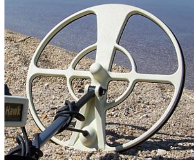
4.9: Teleskopik Çubuğa monte edilen Bobin Arama
