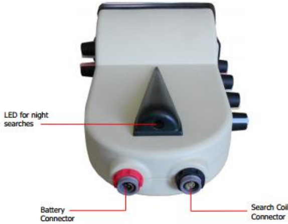
5.3: Pil ve bobin konektörlerini gösteren ünitenin arkası
