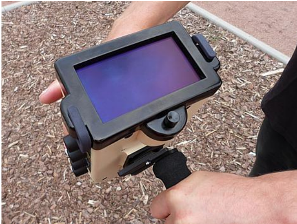
4.6: Sabitlemek için kontrol ünitesinin döndürülmesi
