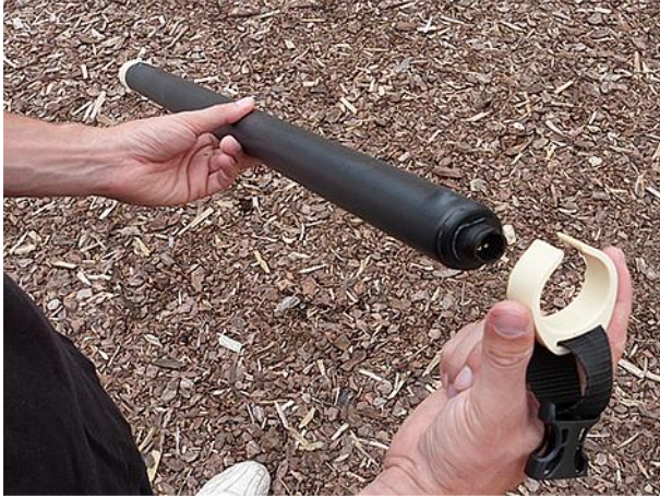
4.12: Bant klipsini bobin segmenti üzerinden itin
