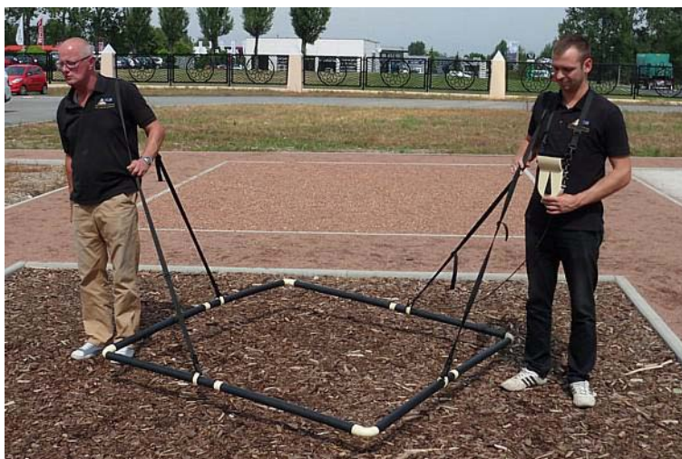
Ilustración 4.20: La bobina de marco también puede realizarse por 2 personas
