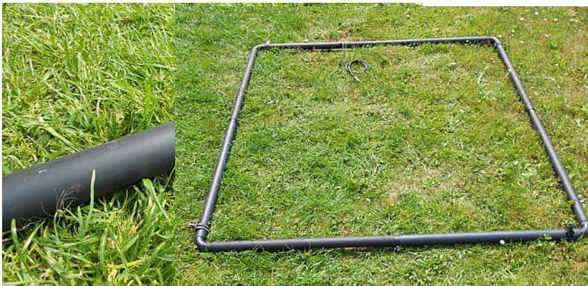
Ineinanderschieben der geraden Rohre
